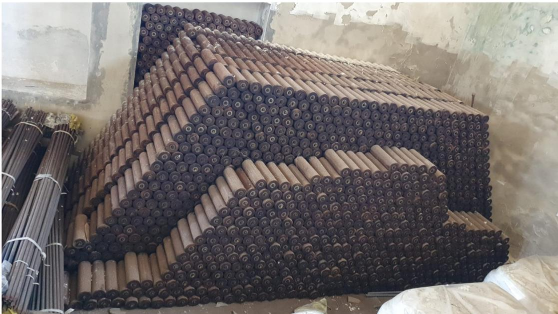
Foto 1 - rulli di mandata nastro trasportatore: peso complessivo circa 24 tonnellate
