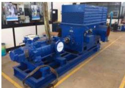
Avviate le modifiche Impiantistiche a livello -400 e -150, ed il montaggio della prima Elettro-Pompa. Primo avviamento è avvenuto nell'estate 2018, ottenendo una riduzione assorbimenti pari a circa il 25%.
