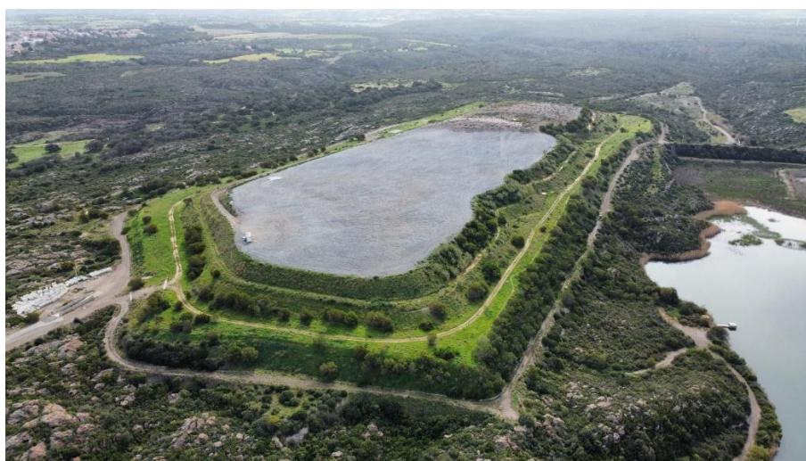
Fig. 2 – Discarica RNP Carbosulcis – Stato dei lavori al 11/03/2025 (completata stesura materiale drenante)
