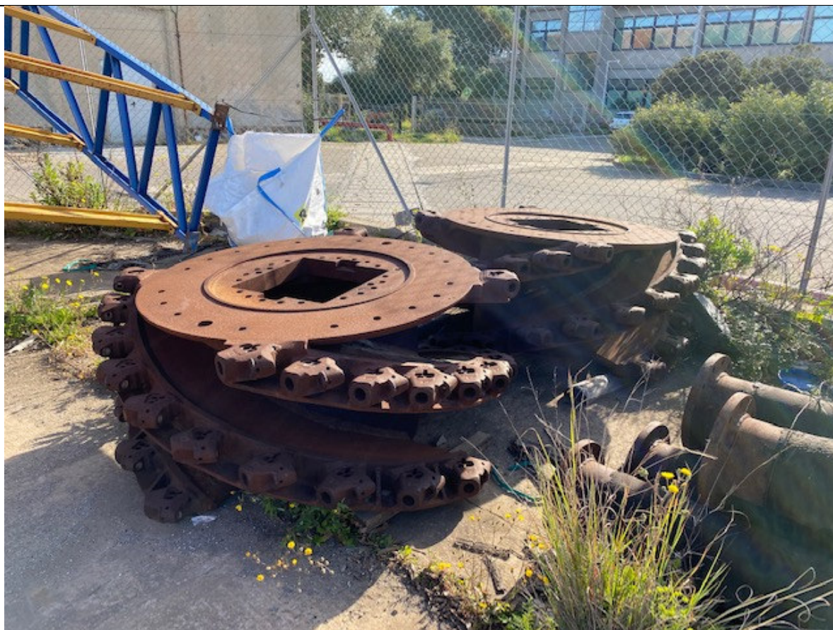
Foto 4 – n° 2 tamburi tagliatrice: peso complessivo circa 7 tonnellate
