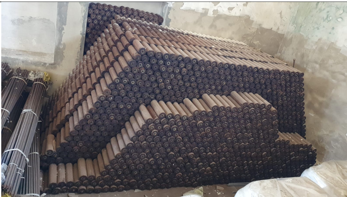
Foto 2 - rulli di mandata nastro trasportatore: peso complessivo circa 24 tonnellate
